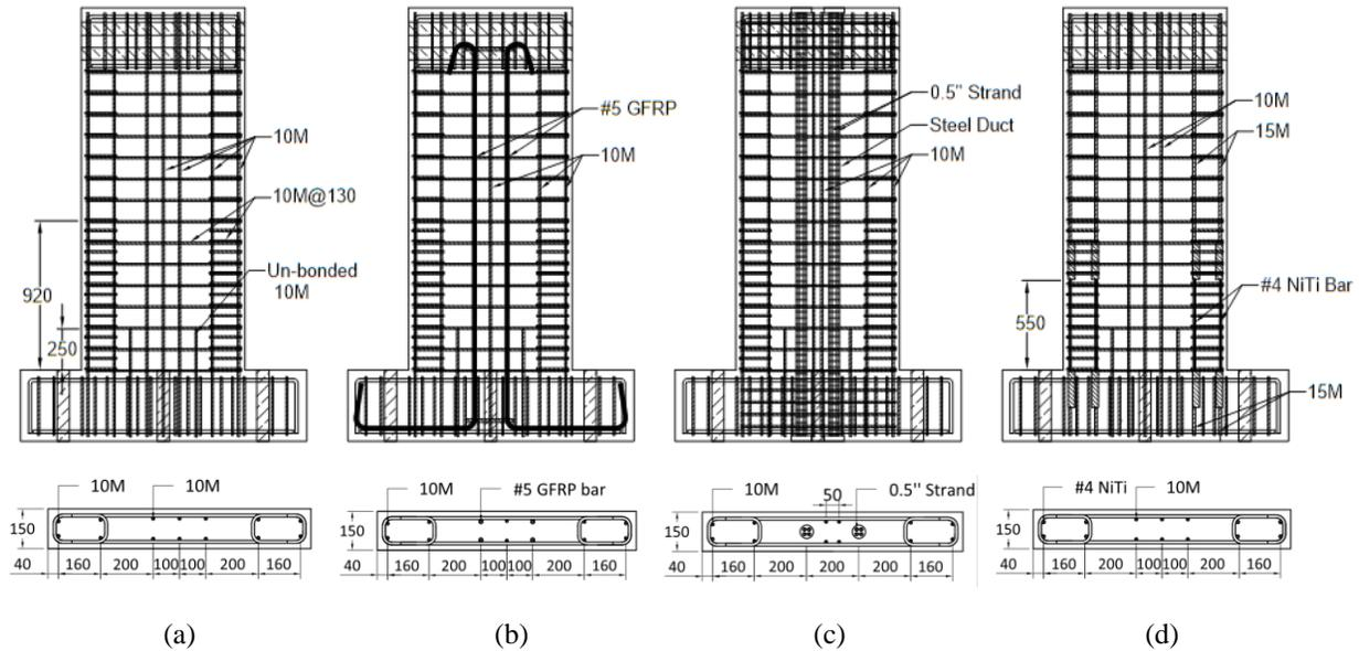
Figure 1. Reinforcement layouts of specimens: (a) CW, (b) GFRP-ECC, (c) PT-SFRC, (d) SMA-SFRC.
